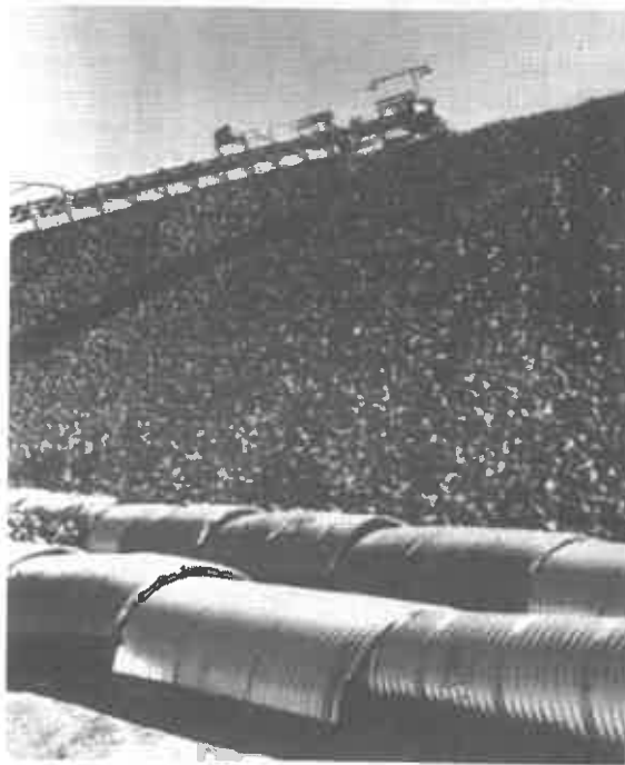
تصویر ۶-۱۴ سقف پلاستیکی طاقی شکل با هوای فشرده برای پائین آوردن درجه حرارت ریشه. (American Crystal Sugar Co. Moorhead, Minnesota)
